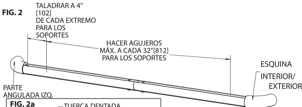
3. Taladre agujeros en la línea central del perfil de aluminio para los soportes, utilizando una broca de 1/4" (6mm). Sujete las piezas anguladas, las esquinas interiores y las esquinas exteriores al perfil.
